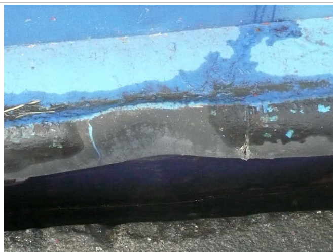
Фотография 3.10. Внешний вид Объекта оценки (правый борт, внешние дефекты корпуса)
